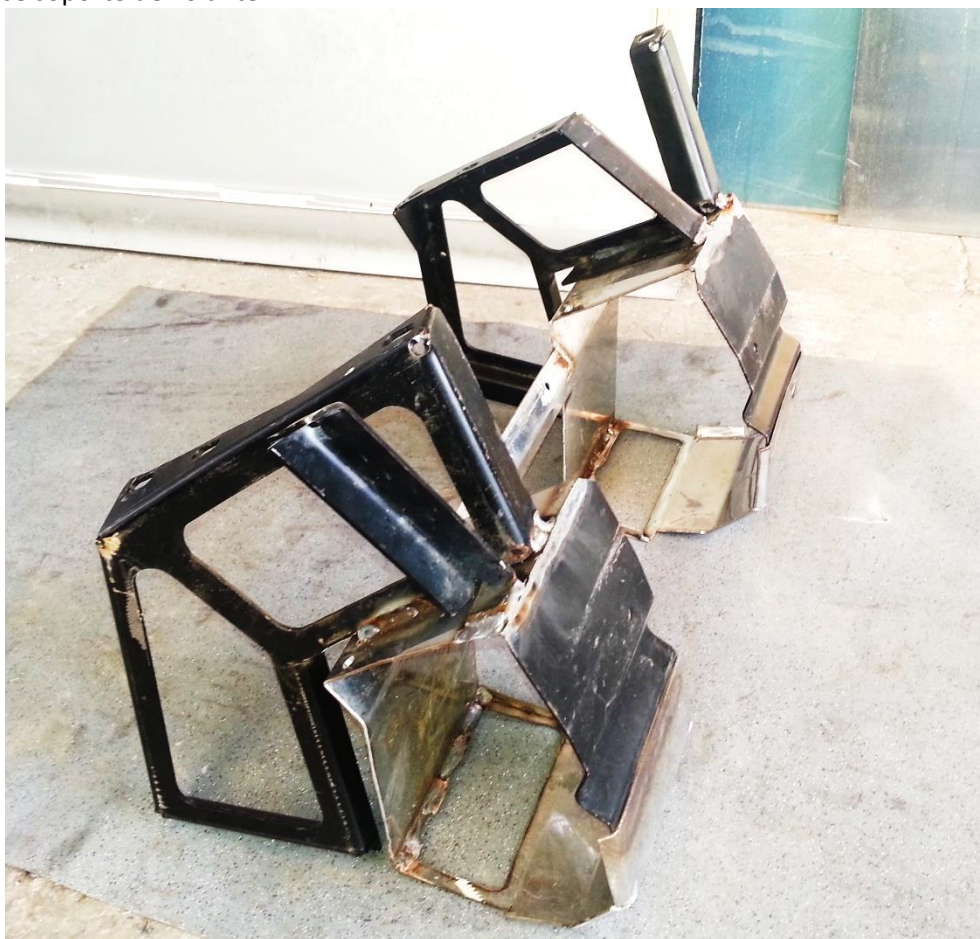
Reparación de base soporte de volante
